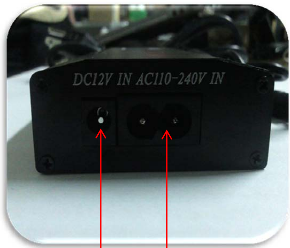
ENTRADA DE VOLTAJE 12 Vcc AUTOMOVIL.
